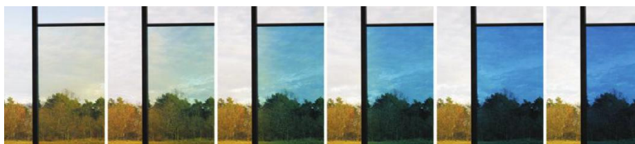
1.9 att. Vācijā, Berlīnē ražota secīga elektrochromā loga pārslēgšanās [24]
