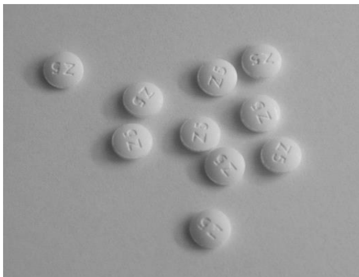
26. attēls. Zopiklona placebo tablešu kodoli 010514 sērijas pēc nobirzuma testa veikšanas
