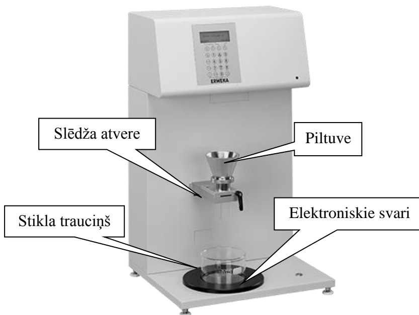
9. attēls. Birstamības testeris (Total Lab Systems., 2013)
