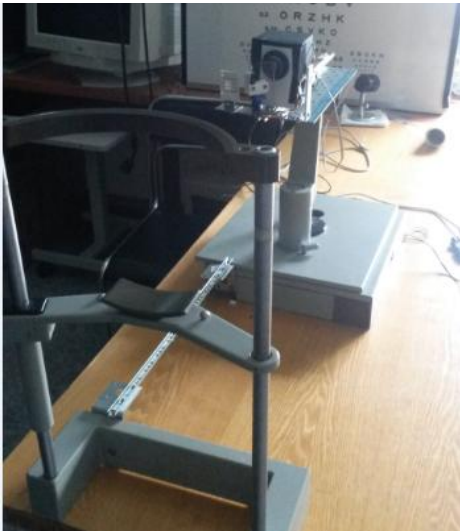
2.2. att. Modificētā dinamiskā retinoskopa iekārta ar zoda balstu. Attālums no fiksācijas objekta līdz zoda balstam 40cm.
