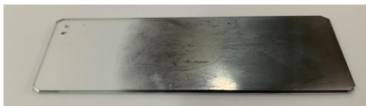
2.2. att. Uzsintezētais \text{Bi}_2\text{Se}_3 plānās kārtiņas paraugs uz stikla pamatnes
