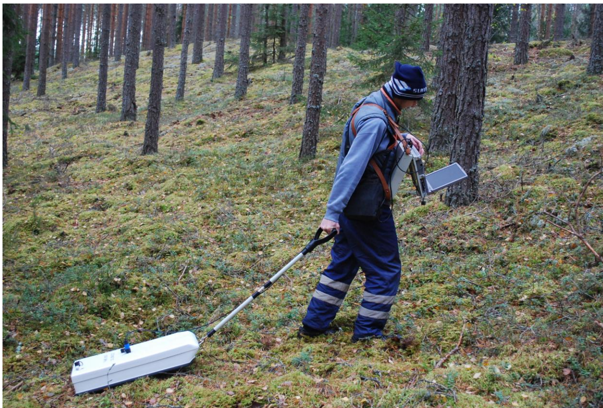
3.4. attēls. Radiolokācijas pētījumu veikšana Kampiņu apkārtnē , izmantojot ģeoradaru Zond-12e un 500 Mhz antenu sistēmu. (J. Karuša foto).
