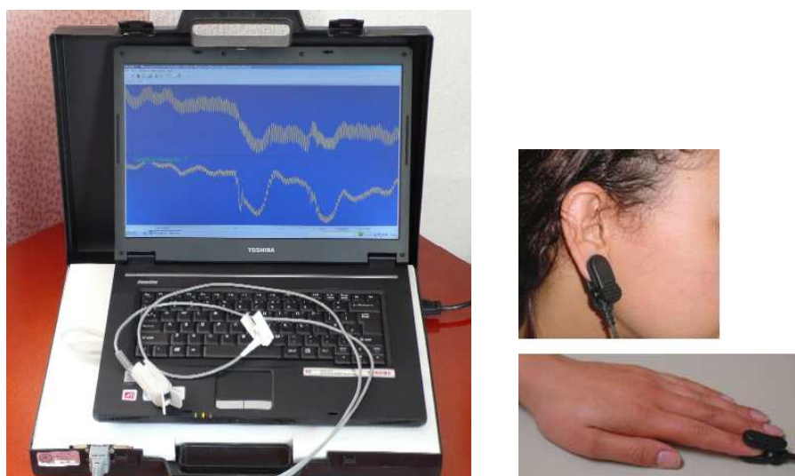
3.5.attēls. Divkanālu PPG reģistrēšanas ierīce (pa kreisi) un sensoru pieslēgums (pa labi).
