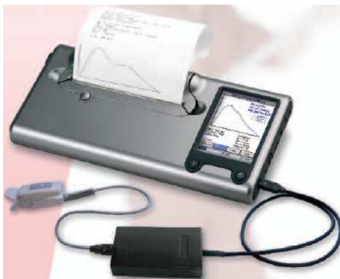
2.14.attēls. Ierīce refleksijas indeksa un stinguma indeksa noteikšanai no PPG pulsa formas („Pulse trace PCA-2” Micro Medical, UK ).
