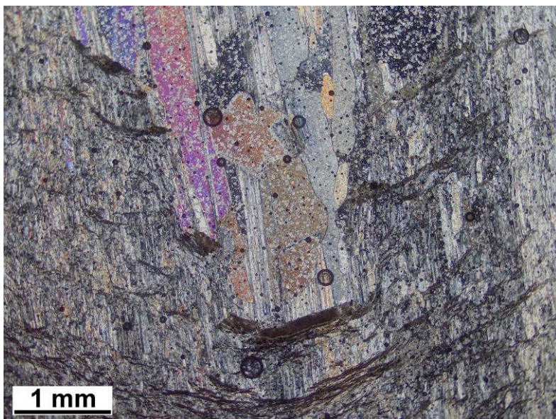
7.73. attēls. Plānslīpējuma mikrofotogrāfija: šķiedru ģipsis ar celestīna konusiem (abās malās). Attēlā redzama konusu savienošanās vieta, un tā robežā ar šķiedru ģipsi ir mālaini dolomītiska materiāla piejaukumi (tumšais). Paraugs „celestīns platais”. Augšējā devona Salaspils svīta, Salaspils ģipša karjers, nikoli krustoti. Fotografējis autors.
