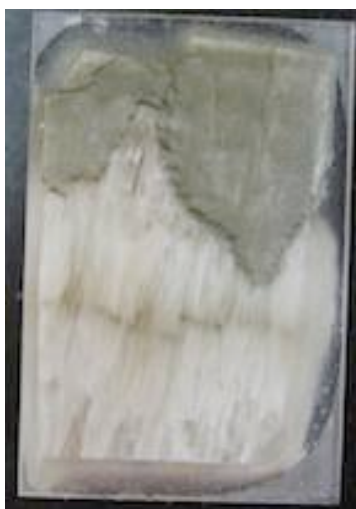
7.71. attēls. Makroparauga fotogrāfija: šķiedru ģipsis ar diviem platiem celestīna konusiem. Attēlā redzams celestīna konusi (augšējā daļā) ar nelieliem mālaini karbonātiska materiāla ieslēgumiem. Paraugs „celestīns platais”. Parauga augstums ir aptuveni 5 cm. Celestīna konusu kontūra piejaukumu dēļ ir pelēcīga. Fotografējis autors.
