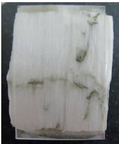
7.3. attēls. Makroparauga fotogrāfija: šķiedru ģipsis ar celestīna konusu. Attēlā redzami divi celestīna konusi, viens no kuriem ir vērsts uz leju (apakšā, labajā malā), bet otrs vērsts uz augšu (augšā, labajā malā). Celestīna konusu kontūra piejaukumu dēļ ir pelēcīga. Labi redzama arī šķiedru ģipša sutūrlīnija, uz kuras koncentrējas mālaini karbonātiska materiāla piejaukums. Makroparauga augstums ir 5 cm. 1. paraugs. Fotografējis autors.
