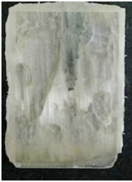
7.76. attēls. Makroparauga fotogrāfija: šķiedru ģipsis ar celestīna konusu. Attēlā redzams celestīna konus (centrālā augšējā daļā) ar mālaini karbonātiska materiāla ieslēgumiem. Paraugs „caurcelest”. Celestīna konusu kontūra piejaukumu dēļ ir pelēcīga. Fotografējis autors.
