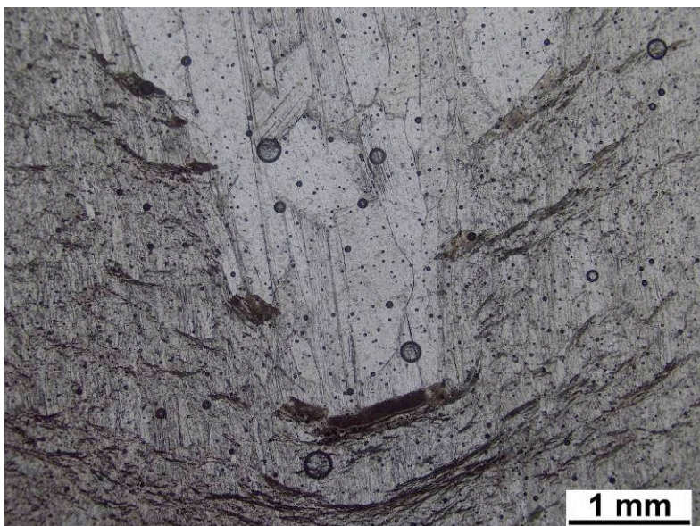
7.72. attēls. Plānslīpējuma mikrofotogrāfija: šķiedru ģipsis ar celestīna konusiem (abās malās). Attēlā redzama konusu savienošanās vieta, un tā robežā ar šķiedru ģipsi ir mālaini dolomītiska materiāla piejaukumi (tumšais). Paraugs „celestīns platais”. Augšējā devona Salaspils svīta, Salaspils ģipša karjers, nikoli paralēli. Fotografējis autors.
