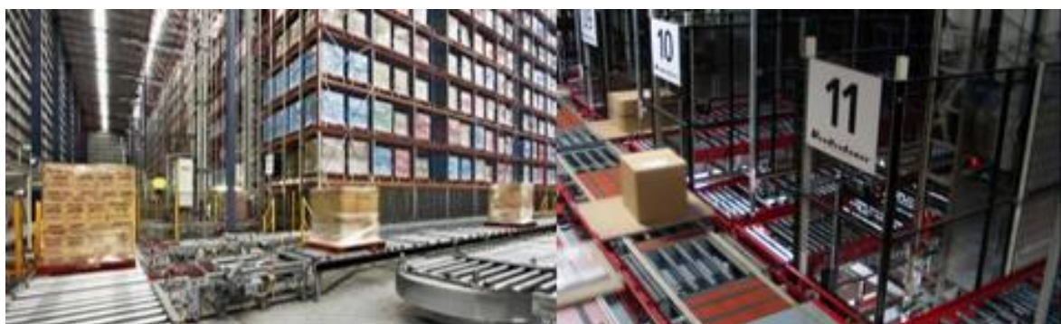
1.att. Vertikālā automātiskā augstplauktu noliktavas sistēma
