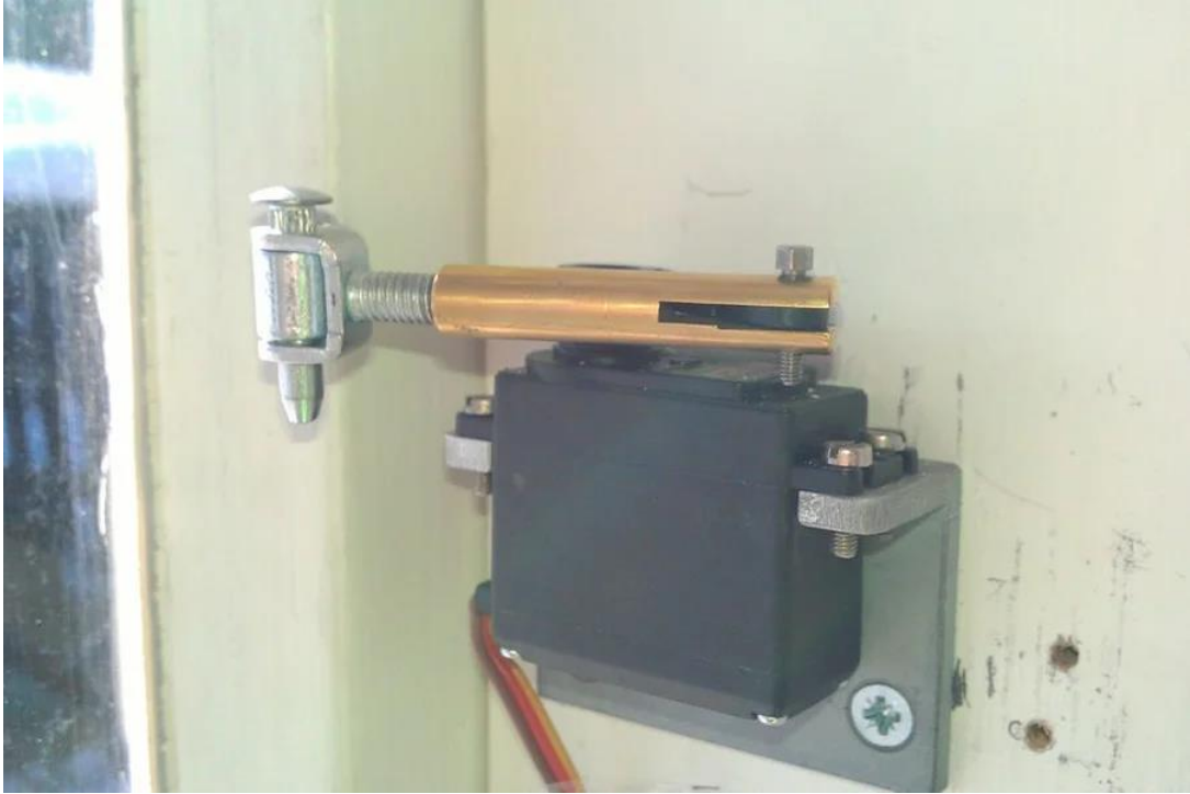
2.4.2.1. att. Loga atvēršanas mehānisms, izmantojot servomotoru 2 .
