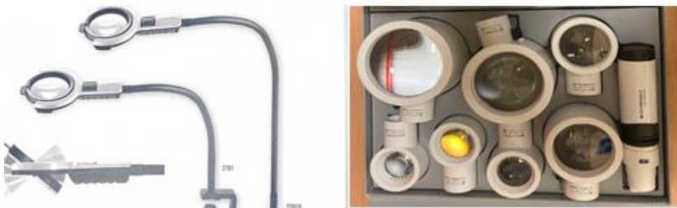
1.2.att. Mainīga fokusa statīvlupas (attēlā pa kreisi) un fiksēta fokusa statīvlupas (attēlā pa labi). (Autors veidots, atsaucoties uz Jackson et al., 2007).
