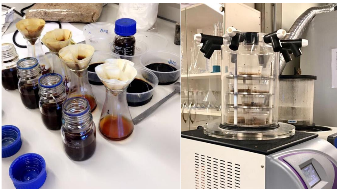
2.4.1. attēls . Čagas paraugu sagatavošana. A – titrēšana, B – liofilizēšana (Autora attēli).
