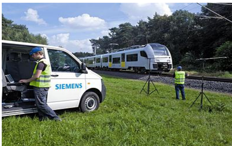
1.4.2.1. att. Ie. Trokšņa mēršana izmantojot mikrofonus, kas savienāti kopā ar datoru (Siemens, 2012).
