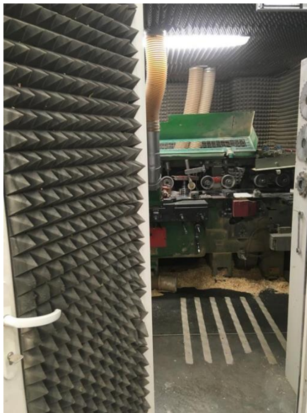
4.5. att. SIA “ JELD-WEN Latvija “ trokšņa izolējošas kameras izveidošana ap apzāģēšanas iekārtu Dobeles rūpnīcā
