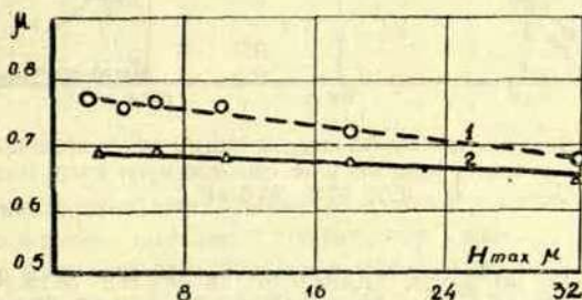
Фиг. 3. Зависимость коэффициента трения от шероховатости при нагрузке 3.0 кг для скоростей 3.80 м/мин. (кривая 1) и 400 м/мин. (кривая 2).
