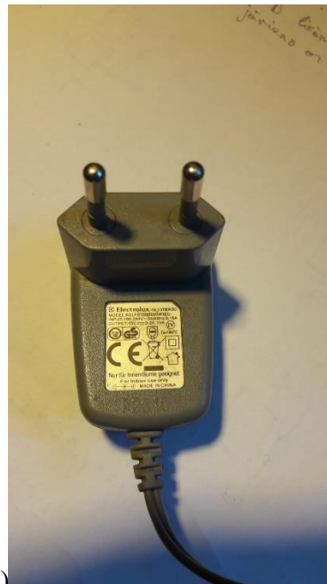
2.2 att. AC/DC adapteri ar izejā dodošu a) 9 V; b) 18 V spriegumu
