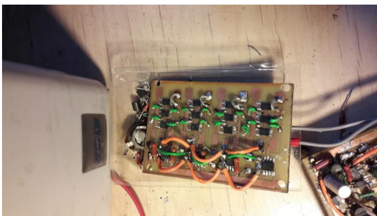
2.5 att. Optiskās atsaistes shemotehnika ar tālāk sekojošo draiveru kaskādi
