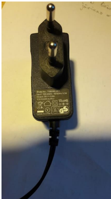
2.2 att. AC/DC adapteri ar izejā dodošu a) 9 V; b) 18 V spriegumu
