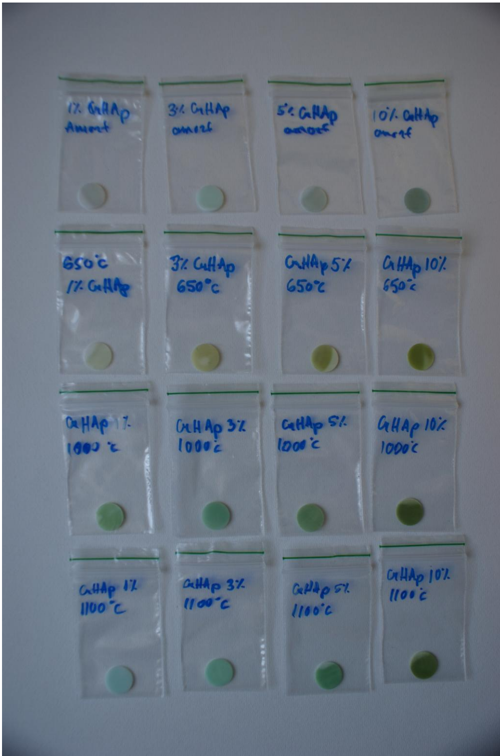
2. att. FTIR spektru analīzei sapresētās 1, 3, 5, 10% CrHAp termiski apstrādāto paraugu tabletes
