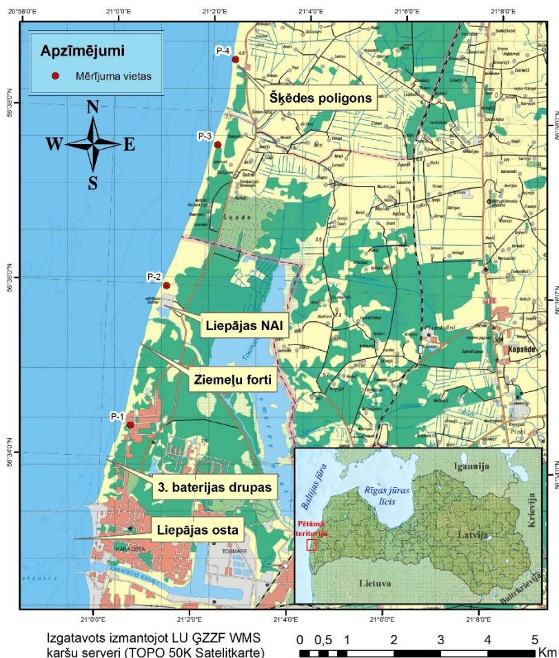
2.1. attēls. Pētījumā izmantoto krasta nogāzes nivelēšanas profilu novietojums pētījuma teritorijā (Izstrādājis autors, izmantojot satelīt karti 50K M 1:80 000)
