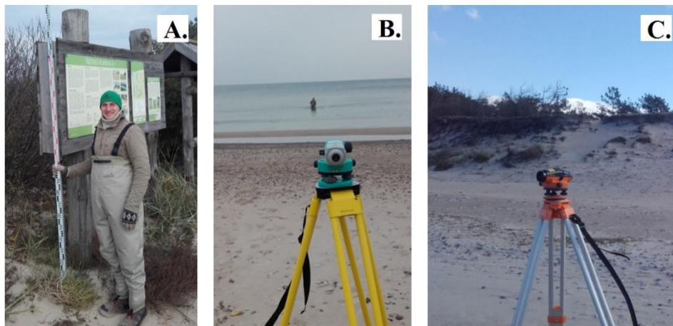
3.1. attēls. Mērnieks ar ūdens necaurlaidīgo puskombinezonu (A.) Nivelēšanas darbi ūdens seklūdens daļā ar GeoStar Ak-32 optisko nivelieri (B.) Nivelēšanas darbi virsūdens daļā ar Geo Fennel FN24 optisko nivelieri (C.) (Autora foto)
