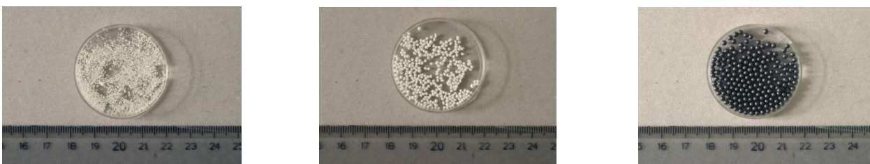
1.2.attēls. \text{Li}_4\text{SiO}_4 minilodītes (pa kreisi), \text{Li}_2\text{TiO}_3 minilodītes (vidū) un Be lodītes (pa labi) [7-9]
