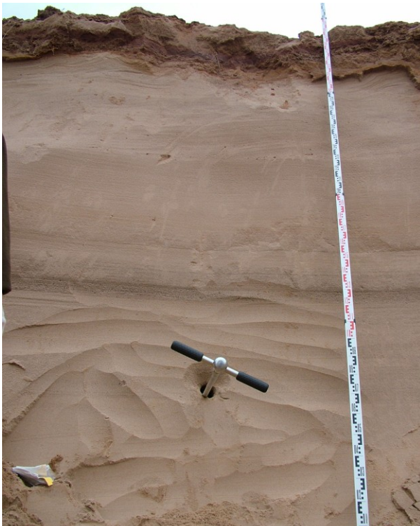
2.1. attēls. Smilts parauga noņemšana OSL datējumu veikšanai “Jaunajā Silnieku” karjerā
