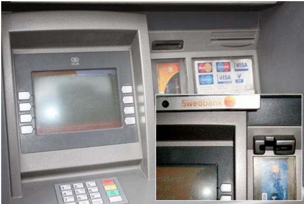
1.4. att. Datu nolasīšanas iekārta (lielā bildē bankomāts bez skimera un ar attēlā pa labi) 1
