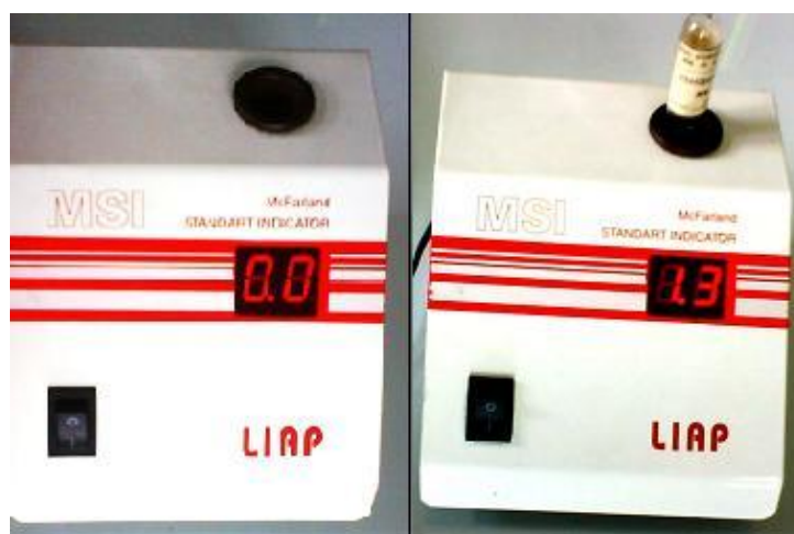
2.2.att. Latvijā ražots spektrometrs šķīdumu duļķojuma pakāpes noteikšanai
