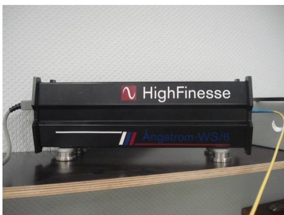
Att. 5. Lāzera starojuma frekvences mērītājs „HighFinesse” WS6
