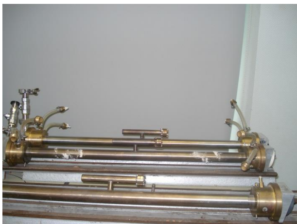
Att. 3. Eksperimentam izmantojamas siltumcaurules ar dažādām sārnu metālu kombinācijām
