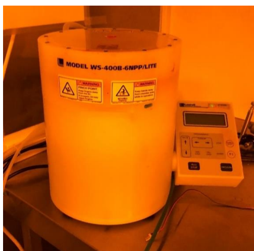
Attēls 16 Rotējošā diska iekārta SPIN coater Laurell WS400
