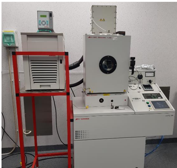
Attēls 18 Termiskās iztvaicēšanas iekārta Thermal evaporator Edwards AUTO 306
