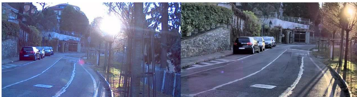
1.2. att. Kamera bez plaša dinamiska diapazona funkcionalitātes (pa kreisi) un kamera ar plaša dinamiska diapazona funkcionalitāti (pa labi)
