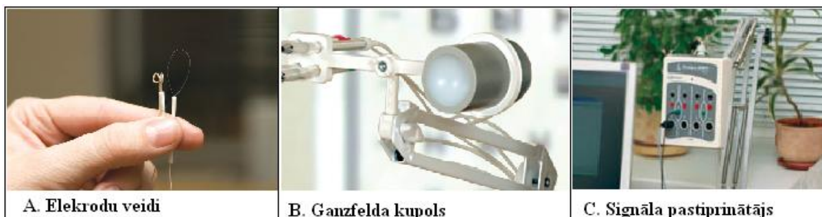
2.1.att. A.) Neuro-ERG aparatūras elektrodi – āķveida un cilpveida; B.) Mini-Ganzfelda kupols, nostiprināts statīvā; C.) Signāla pastiprinātājs.[38]
