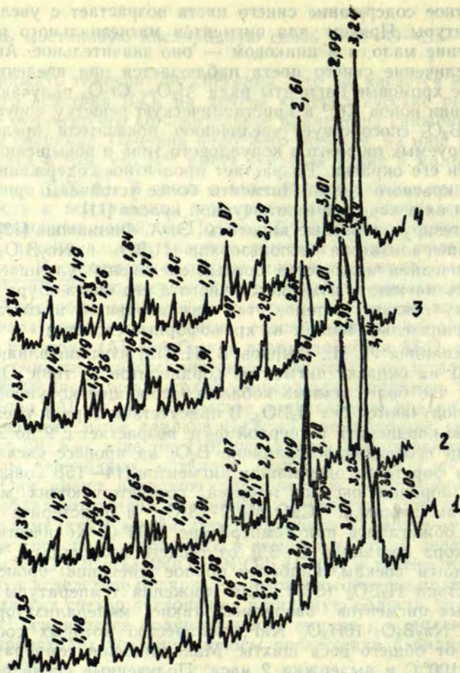
Рис. 1. Рентгенограммы продуктов твердофазовых реакций системы \text{CaO-TiO}_2\text{-SiO}_2 с различными минерализаторами. 1 — без минерализатора; 2 — \text{NaF} , 3 — \text{Na}_2\text{B}_4\text{O}_7 \cdot 10\text{H}_2\text{O} , 4 — \text{H}_3\text{BO}_3 .
