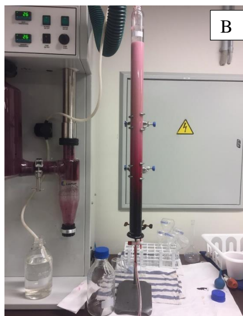
2.2. attēls. Ekstrakta ietvaicēšana rotācijas ietvaicētājā (A) un antociānu desorbciija stikla kolonnā (B)
