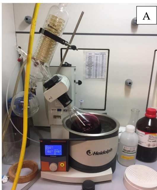
2.2. attēls. Ekstrakta ietvaicēšana rotācijas ietvaicētājā (A) un antociānu desorbciija stikla kolonnā (B)
