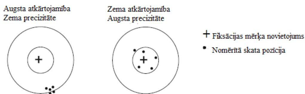
1.4. att. Iekārtu telpiskā precizitāte raksturo atšķirību starp fiksācijas mērķa un noteiktā skata virziena, Atkārtamība raksturo acu kustību iekārtu spēja uzticami atkārtot skata pozīcijas mērījumu ( Nyström et al. , 2012)
