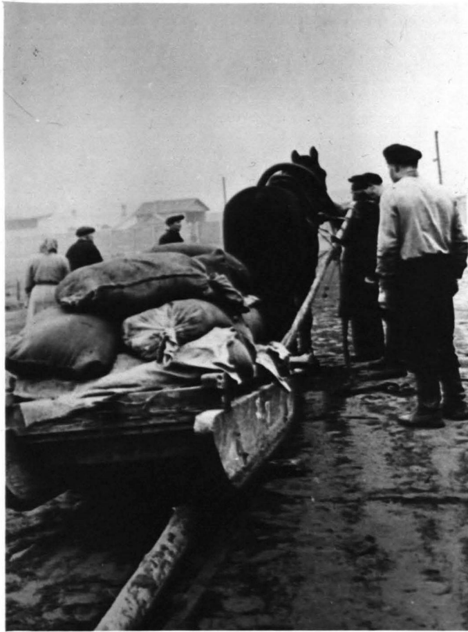
3. attēls. Maksimālā vilkmes spēka pārbaude. Veltnis, palikts zem ragavām, samazina vilkmes pretestību vezuma iekustināšanas brīdī. Vojei- kova sistēmas ragavas.
