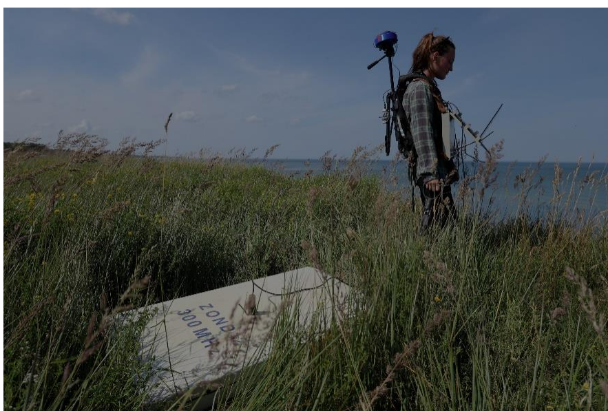
5.2. attēls. Radiolokācijas profilēšanās izmantotais ģeoradars ar 300 MHz antenu un GNSS Emlid Reach antena (K. Lamstera foto)
