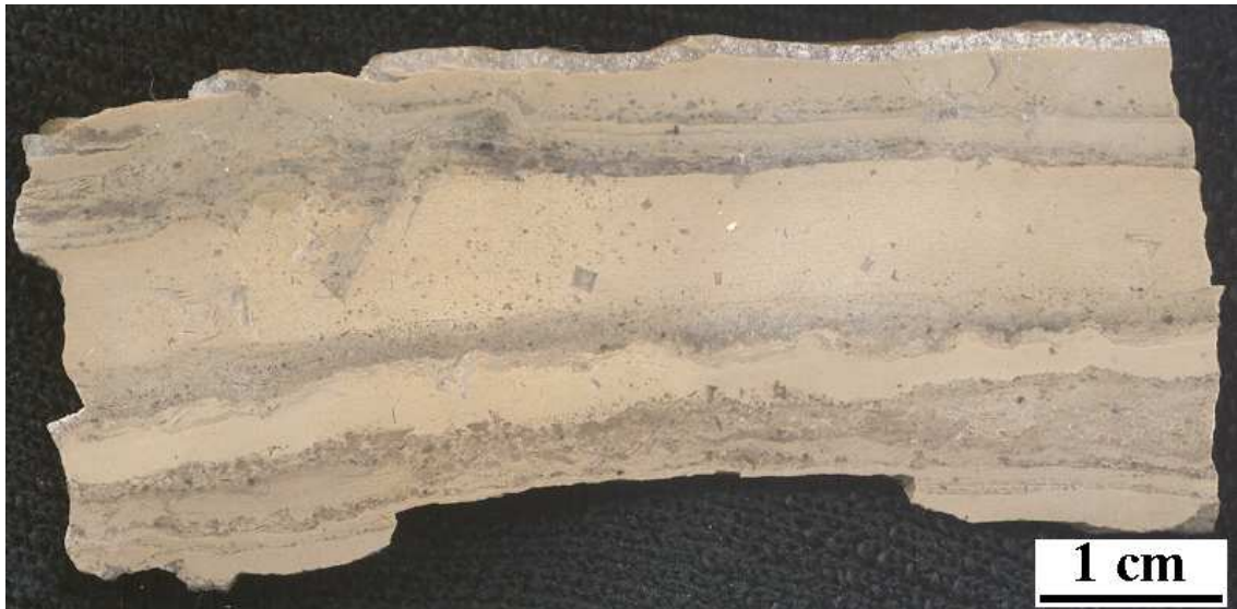
5. att. Parauga nr. 4 makroattēls. Dažāda lieluma halīta pseidomorfozes izkliedētas dolomīta slānī. Halīta kubiskā forma ir labi redzama. Halīta pseidomorfozes aizpilda ģipša kristāli.
