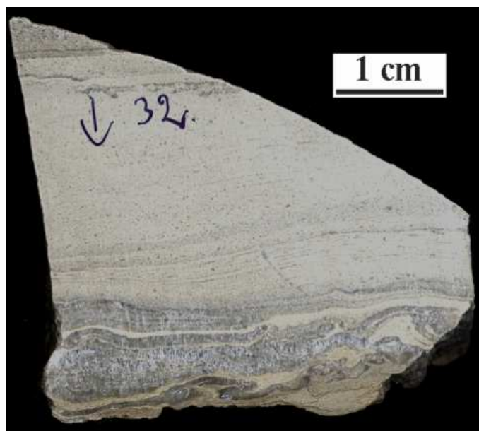
29. att. Parauga nr. 32 makroattēls. Zaļganpelēks dolomīts ar punktveida ģipša ieslēgumiem. Parauga apakšējā daļā deformēta dolomīta, špata ģipša un šķiedru ģipša slāņmija ar liesmu un bumbu un spilvenu tekstūrām attēla apakšējā labajā stūrī.
