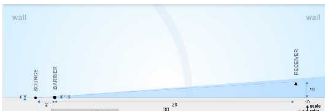
3.26. attēls. Aprēķinātais trokšņa barjeras novietojums un augstums
