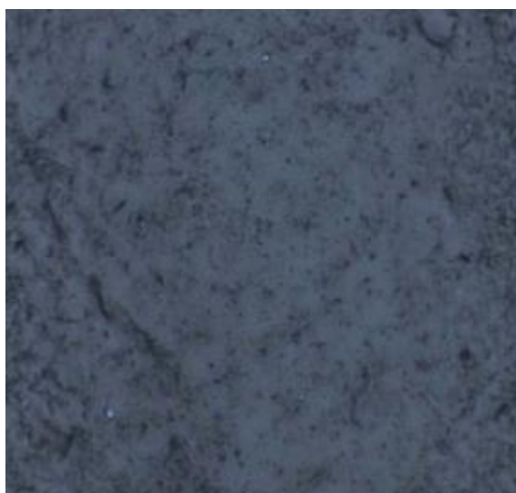
1.9. att. SPĒĒK – ogles kompozītu membrānas virsma ar ogles saturu 0,25%[34]
