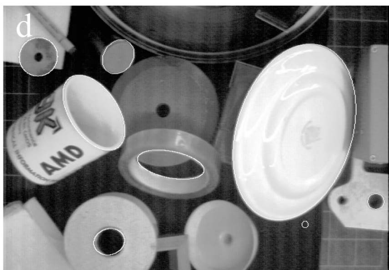
2.13 att. Atpazītās elipses, izmantojot uz lielo pusasi balstīto elipšu meklēšanas algoritmu
