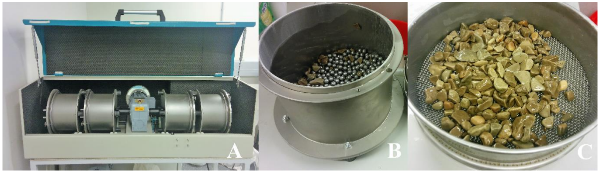
6.4. attēls. Mikro-Devala testa iekārta (A), cilindrs ar šķembu un ložu pildījumu (B) un atlikums 1,6 mm sieta (C) (autores fotogrāfijas)
