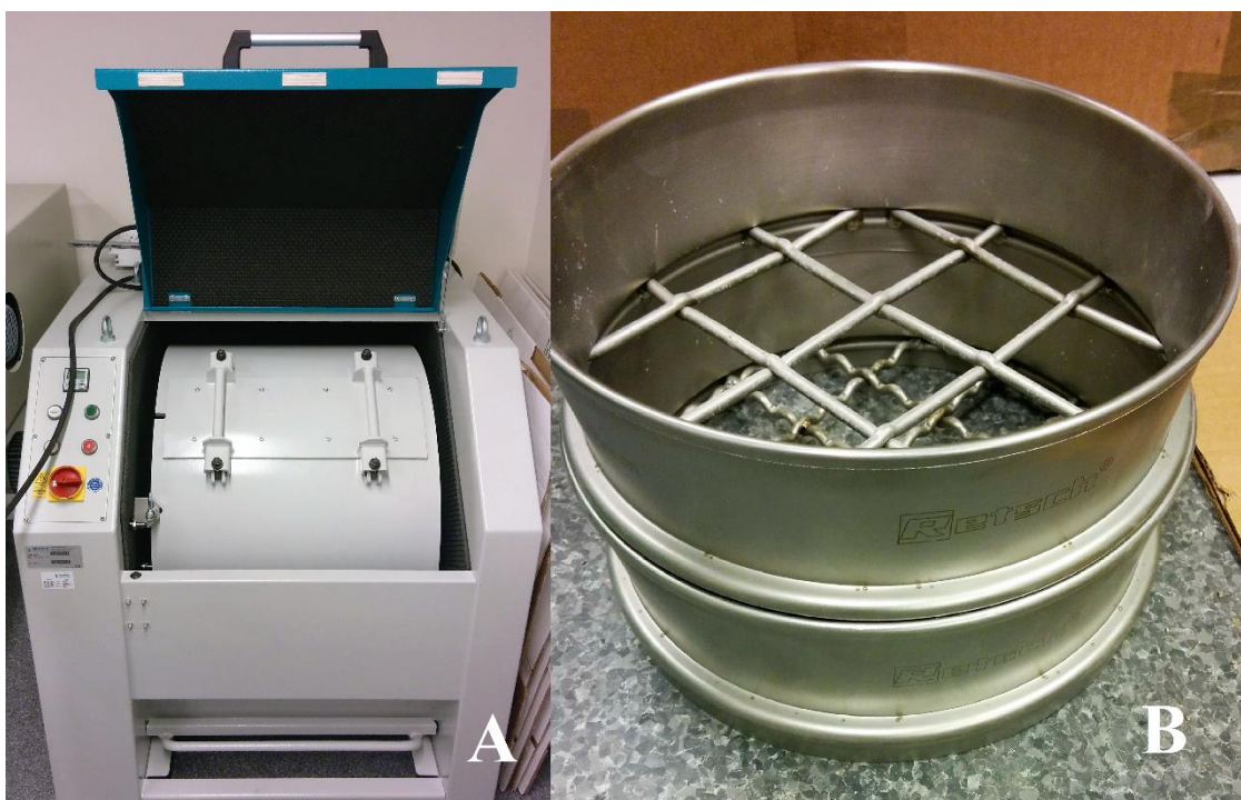
6.3. attēls. Losandželas testa iekārta (A) un paraugu sagatavošanai izmantotie sieti (31,5 un 45 mm (autores fotogrāfijas)
