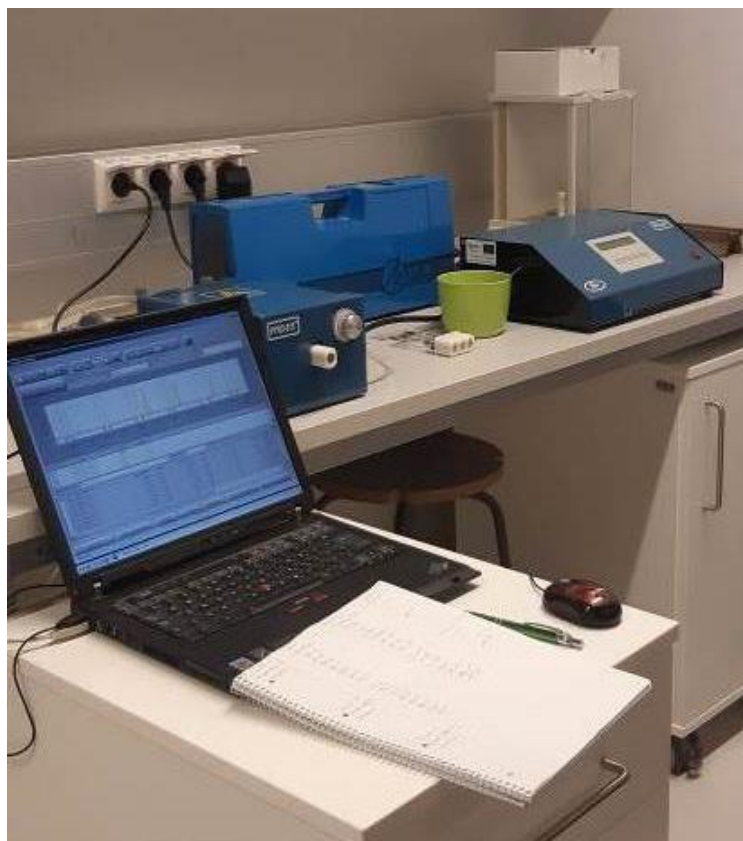
2.10. attēls. Paraugu mērījumi ar atomu absorbcijas spektrometru ar Zēmana korekciju LUMEX RA-915M un tā pievadu pirolītiskajai analīzei PYRO-915+ (autores foto)
