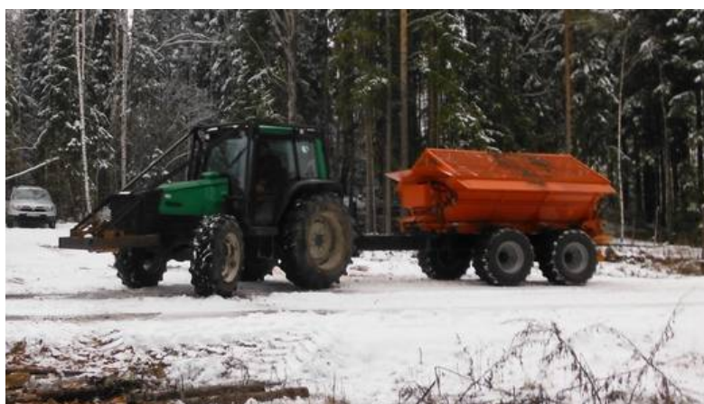
2.2.att. Traktors “Valtra 6350” ar modulāro pelnu klijedēšanas piekabi [83]
