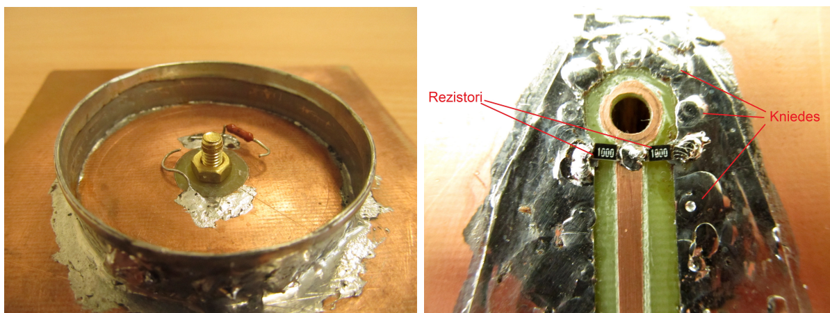
Att. 2.5: (a) Pirmā prototipa plāksnītes augšpusē ar gredzenu, skrūvi un 51 \Omega rezistoru un stiepli salāgojuma un īsslēguma kalibrēšanai, (b) otrā mēriekārtas prototipa rezistoru lodējums salāgojuma kalibrējumam un kniedes gar līnijas malām.
