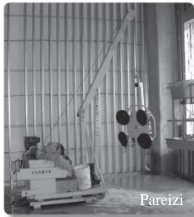
4.10. att. Celšana ar rokām un risinājums: vakuuma smagu nastu pacēlājs [86]
