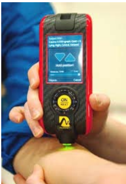
2.2. att. Muskuļu noguruma mērīšana ar miometru Myoton-PRO
