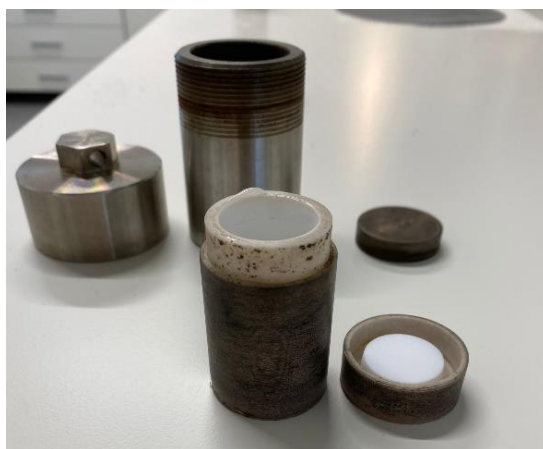
1.3.4. att. Bakalaura darbā izmantotā teflona kamera [20]
