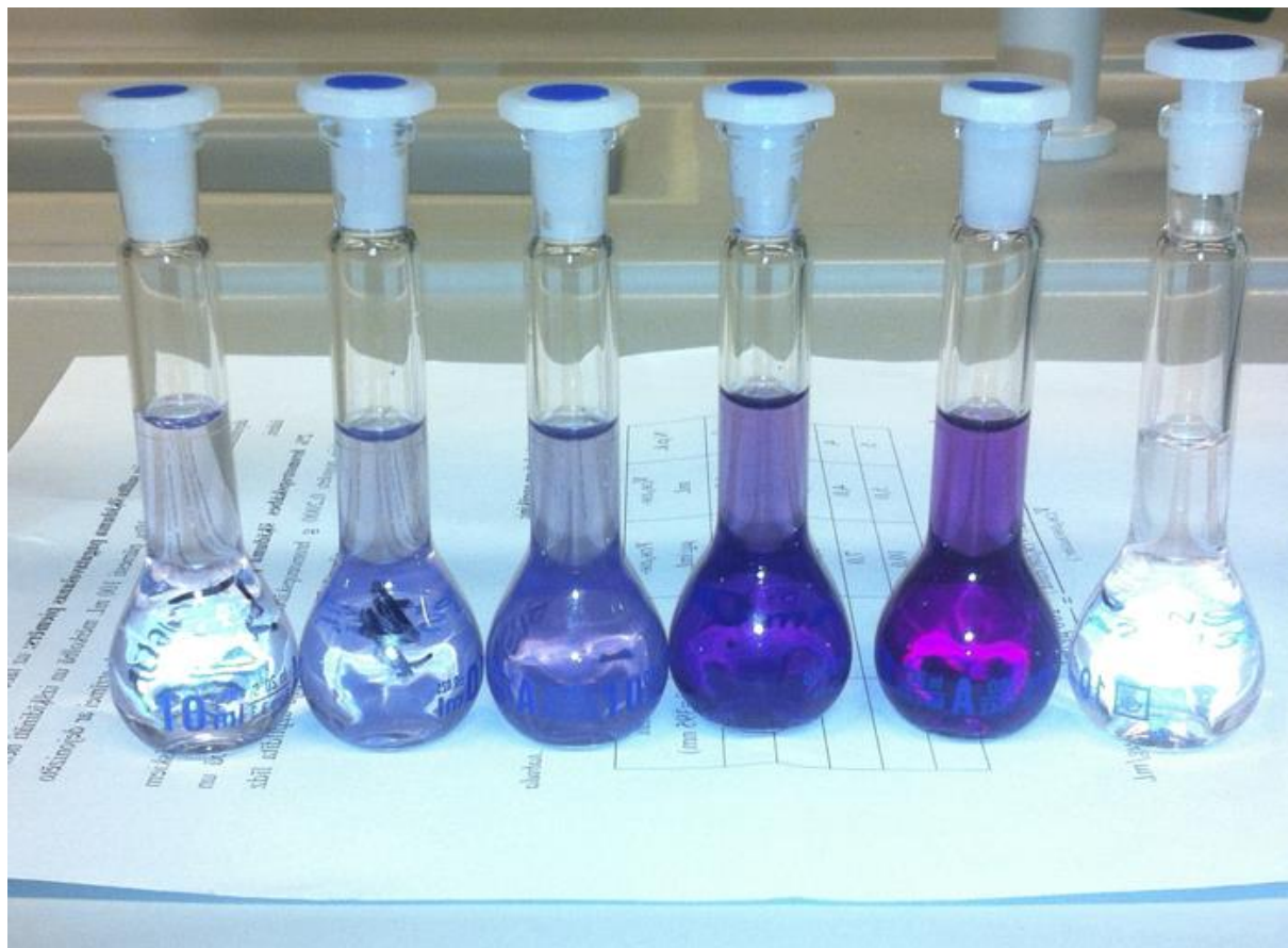
3.2. att. Kalibrēšanas grafikam metanola spektrofotometriskai noteikšanai ar hromotropskābi pagatavotie šķīdumi (20 mg/L, 40 mg/L, 60 mg/L, 80 mg/L, 100 mg/L, tukšais paraugs)
