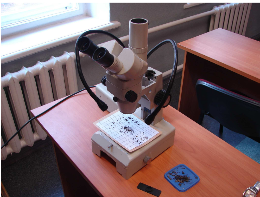
4.4. Att. Paraugu caurskatīšana binokulārajā mikroskopā Nikon SMZ-2T
