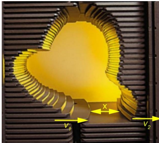
5.3. att. dMLC lapiņu kustību un attāluma starp lapiņām ilustrācija
