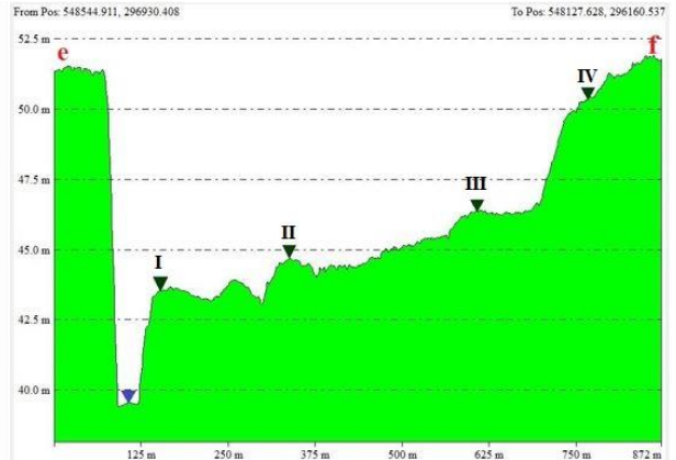
3.9. attēls. Digitālais zemes virsmas modelis un upes ielejas šķēršņi Ogres ielejas lejtecē posmā Aviekstes ieteka - Ogresgals (izveidojis darba autors, 2016; izmantojot LĢIA Lidar datus). Zilais trīsstūris norāda Ogres līmeni, brūnais trīsstūris – palienu, bet zaļais trīsstūris terasi
