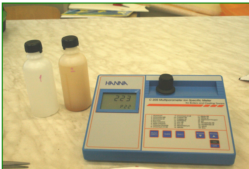
2.6. att. Gruntsūdens paraugu ķīmiskā analīze ar HANNA C205, HI83205 Boilers & cooling towers bench ISM meter (autores foto, 10.11.2008)
