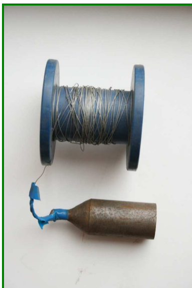
2.3.att. Gruntsūdens līmeņa mērītājs (autores foto, 15.01.2009)
