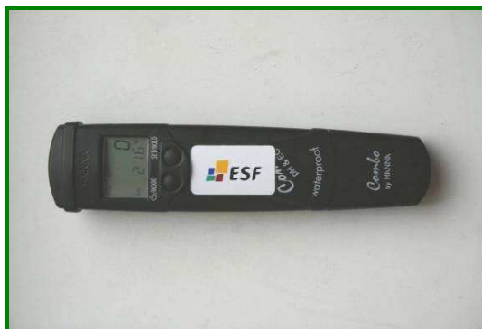
2.4.att. Hanna Combo pH/EC/TDS Tester (autores foto, 15.01.2009)
