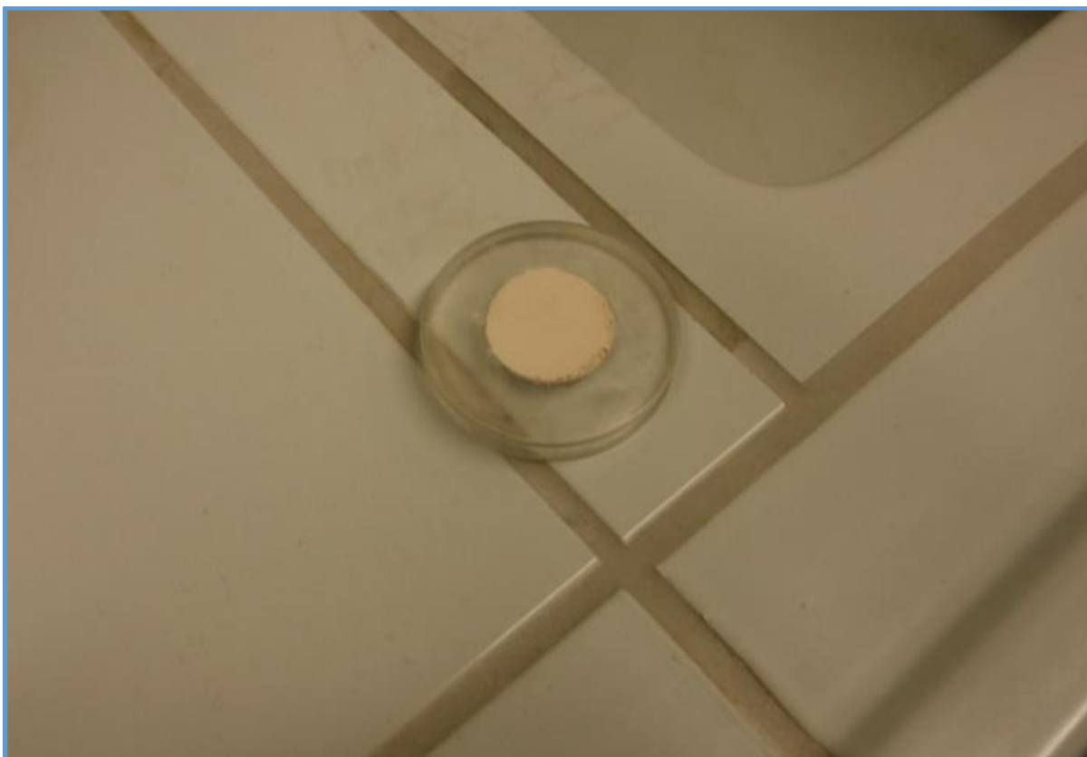
3.19.att. Analizēšanai sagatavots Tukuma karjera paraugs rentgendifraktometrā
