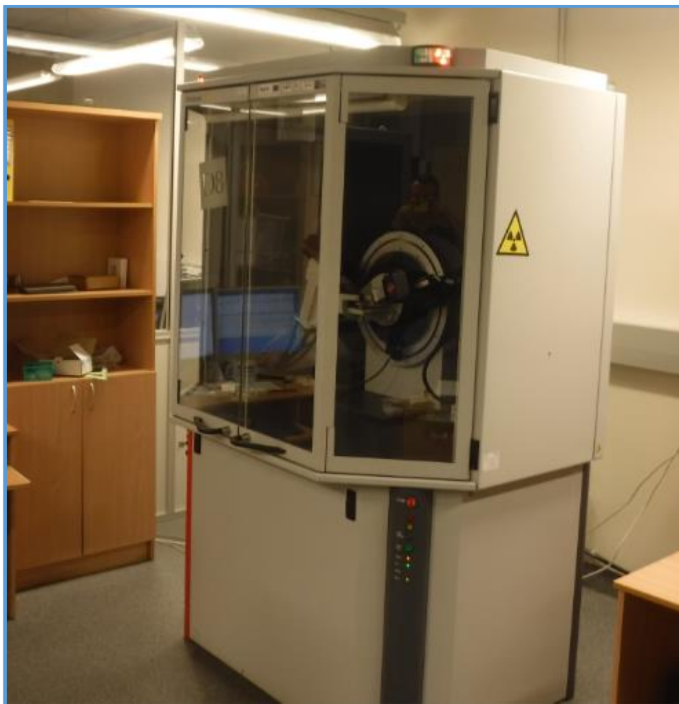
2.1.att.Latvijas Universitātes rentgendifraktometrs D8 Advance, ko ražo uzņēmums “Bruker”
