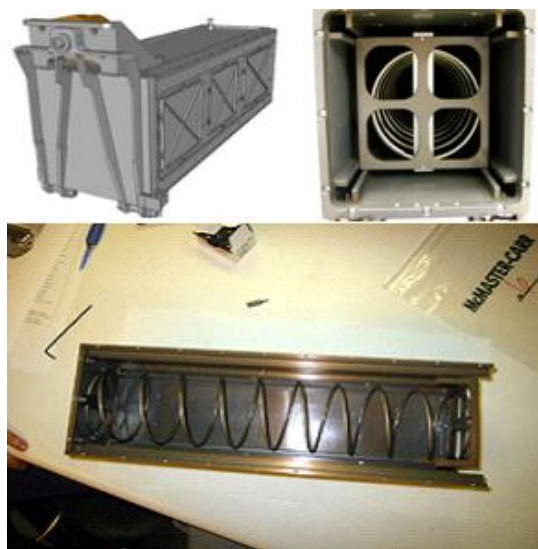
att. 4.3.2. Sistēma satelīta nogādei orbītā P-POD (Tiešsaiste: 50)
