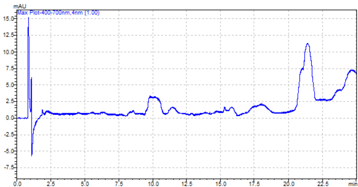
2.att. Melnās zīmogrāses Donau hromatogramma redzamās gaismas apgabalā, kas iegūta apgrieztās fāzes apstākļos
