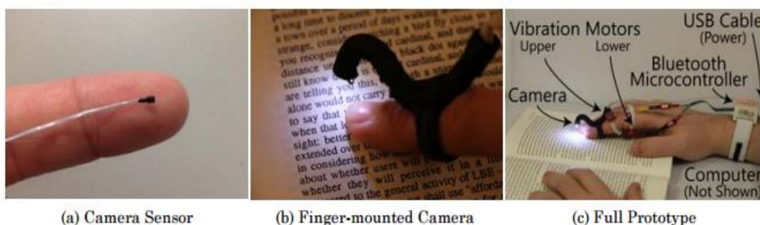
5.2. att. HandSight ierīce, kura neredzīgajiem palīdz lasīt grāmatas, žurnālus, laikrakstus
