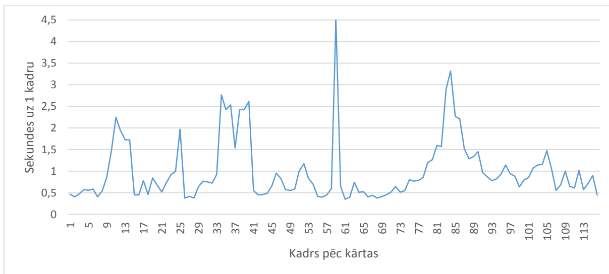
3.28 att. Kadru iegūšanas laiki izmantojot video no testa datu iegūšanas izmantojot divas automašīnas ar vienādiem viedtālruņiem
