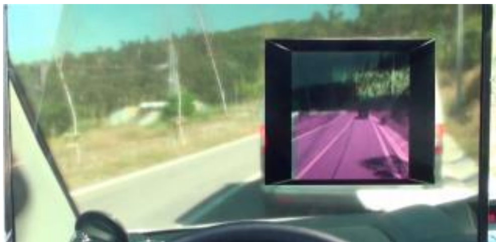
1.5. att. Caur-redzes sistēmas prototips darbībā, attēls no avota [8]
